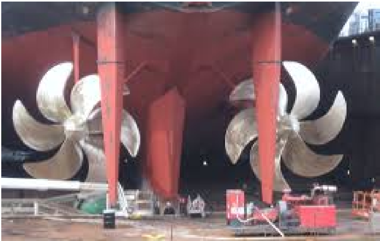
Slika 19. Ljevookretni i desnookretni vijak
