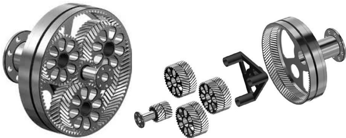
Slika 16. Model planetarnog prijenosa s tri planetarna zupčanika i strelastim ozubljenjem
