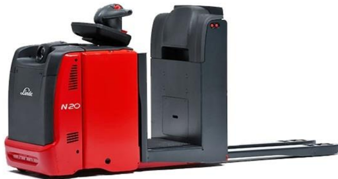
Slika 6. Električni viličar za komisioniranje [10]
