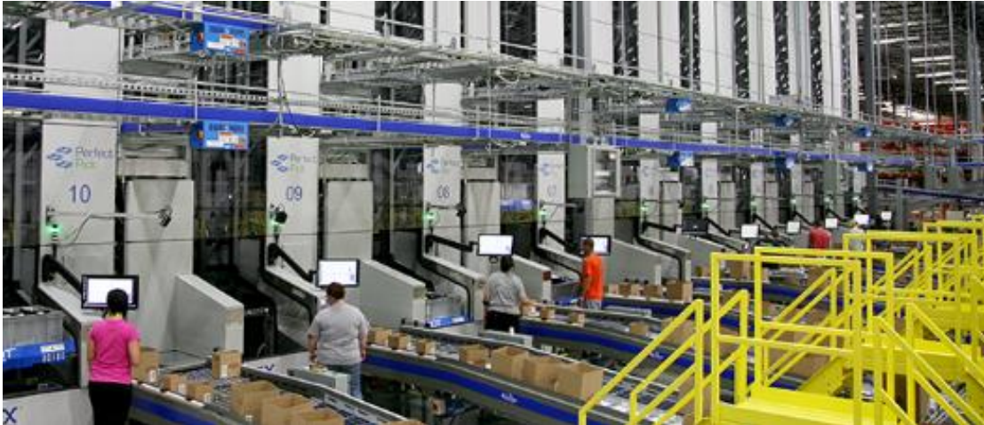
Slika 7. Skladišna mehanizacija za komisioniranje roba-čovjeku [11]
