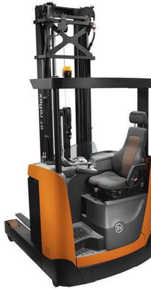
Slika 8. Regalni električni viličar [13]
