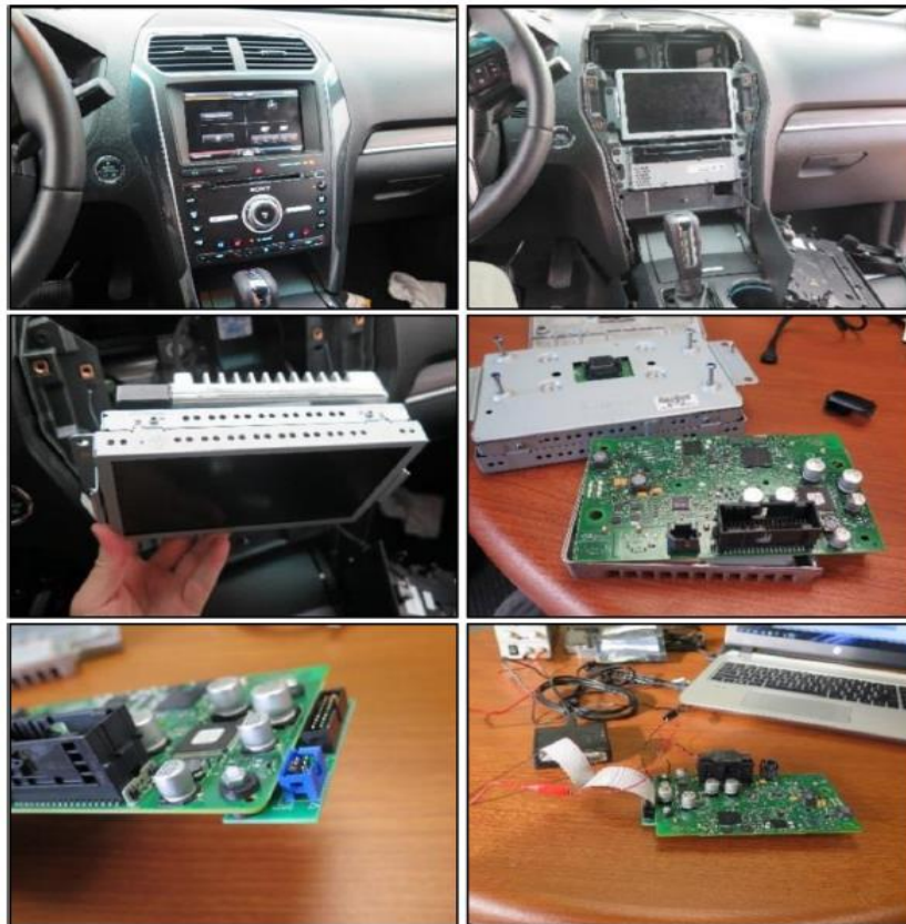
Slika 12. Primjer fizičke ekstrakcije podataka sa Infotainment sustava Ford Sync, [32]
