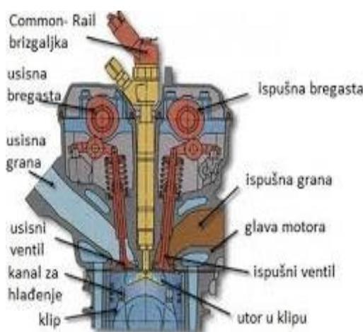
**Slika 1.** Konstrukcija dizel motora, [4]
