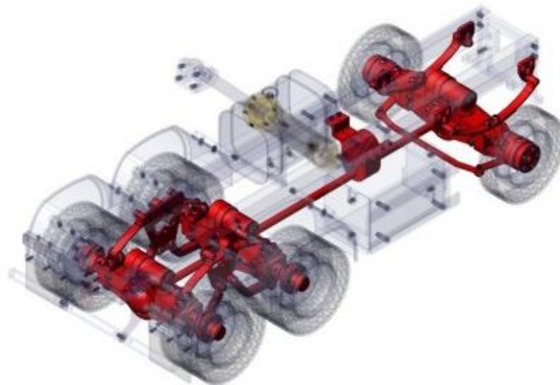
**Slika 5.** Prijenos snage na motornom vozilu sa šest pogonskih kotača, [13]
