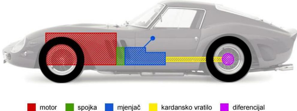
**Slika 3.** Prijenos snage na motornom vozilu sa stražnjim pogonom, [9]
