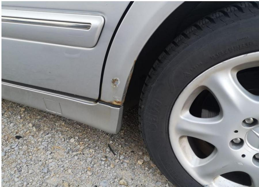
**Slika 11.** Prikaz oksidiranog lijevog ruba na Mercedesu i izbratzane stražnjeg diska, [27]
