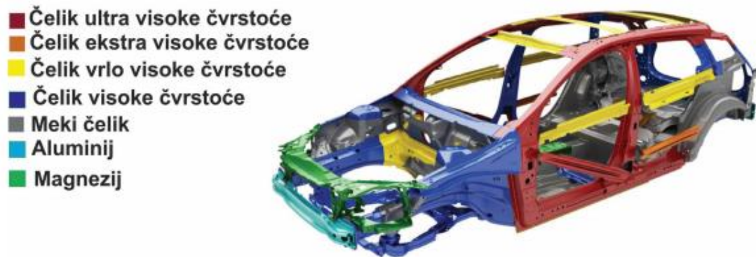
Slika 10. Sastavni materijali rešetkaste karoserije (Volvo, V60), [23]
