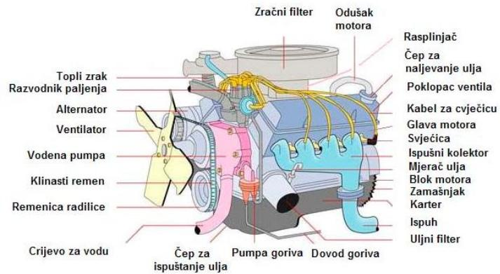
**Slika 2.** Glavni dijelovi motora s unutarnjim izgaranjem, [5]
