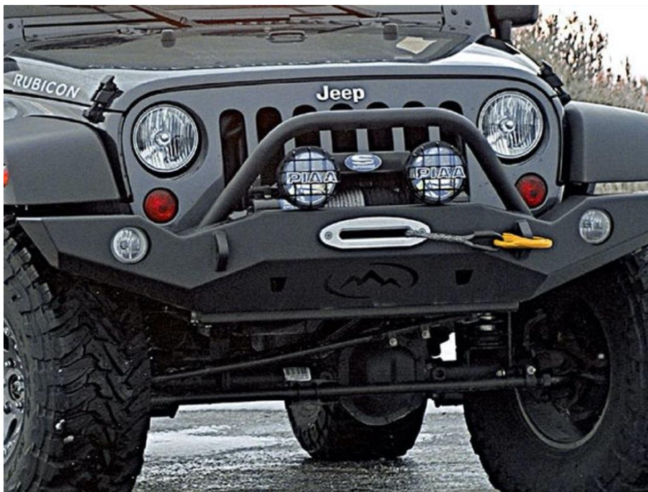
Slika 19. Naknadno ugrađen Bull bar na motorno vozilo
