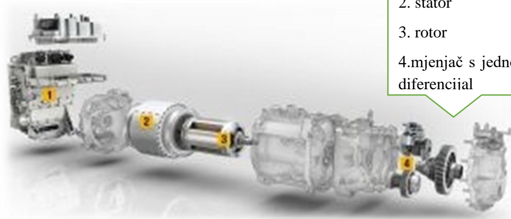
Slika 4. Pogonski sklop Renault Zoea, [2]
