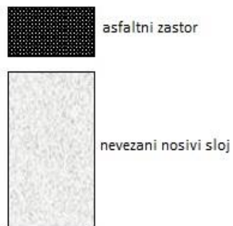
Slika 6. Nosivi sloj od nevezanog kamenog agregata
