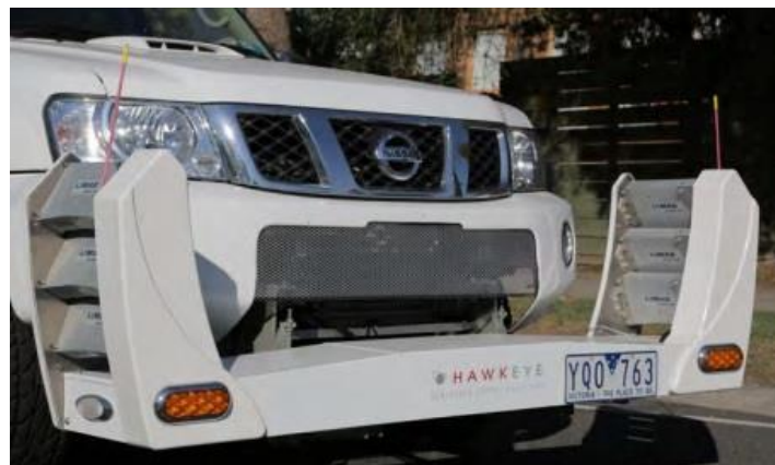
Slika 17. H2000 ACD uređaj za detektiranje pukotina
