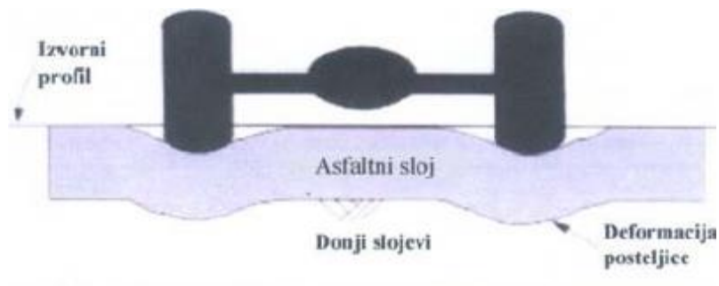
Slika 10. Kolotrazi nastali zbog deformacije slojeva ispod kolničke konstrukcije
