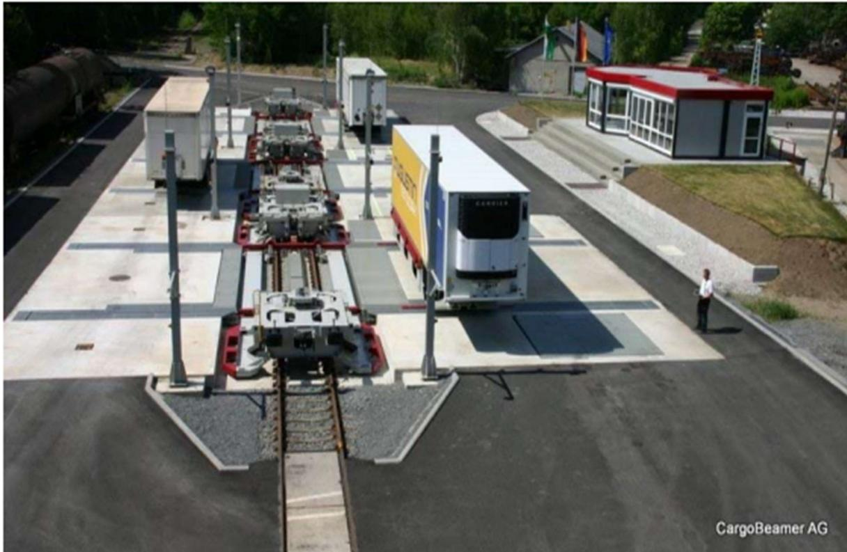
**Slika 6. Prikaz CargoBeamer paralelnog utovara i istovara**
