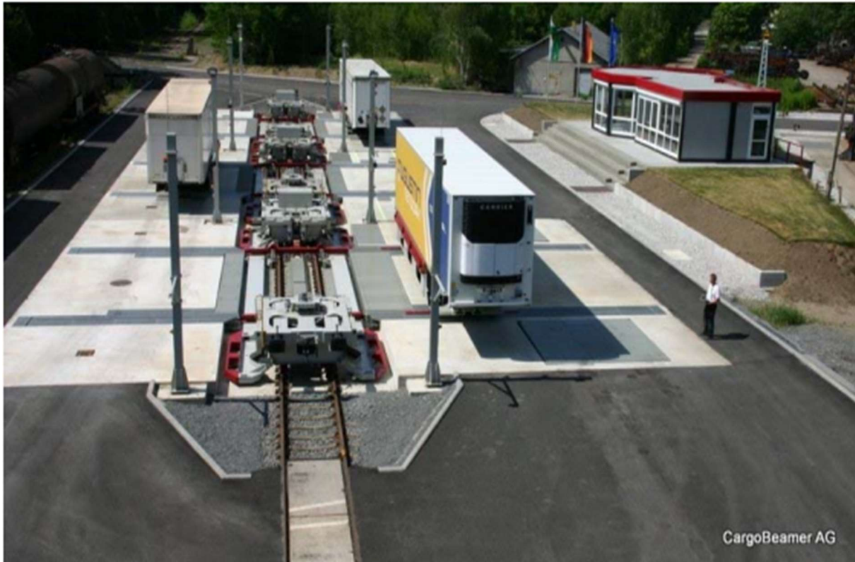
Slika 6. Prikaz CargoBeamer paralelnog utovara i istovara
