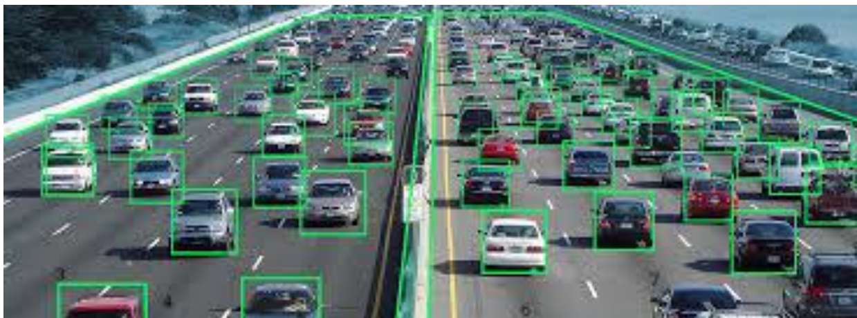
Slika 21. Brojanje prometa pomoću video tehnologije
