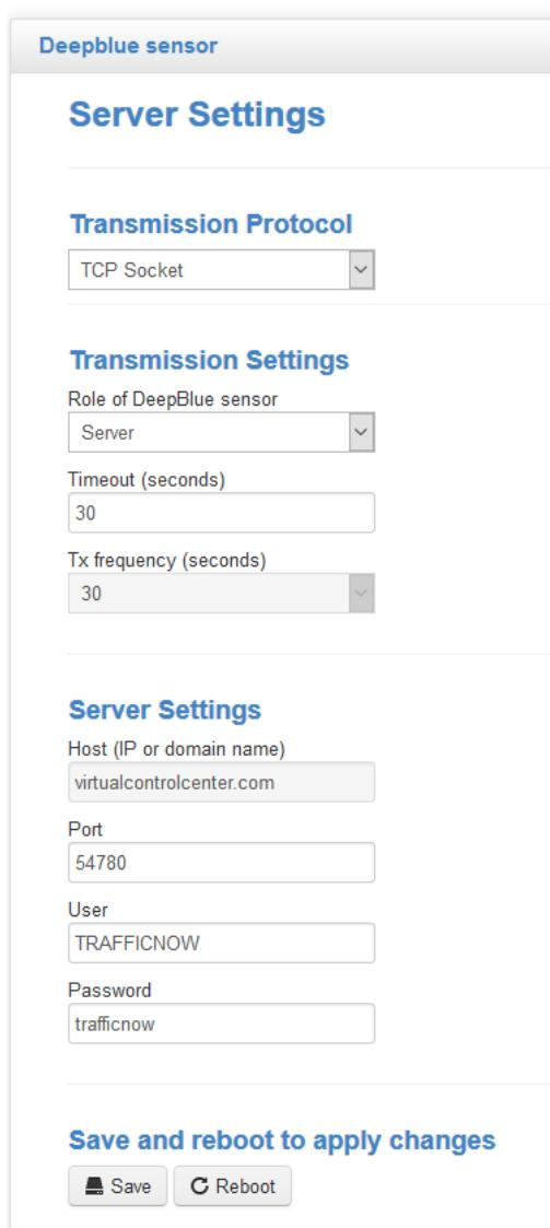
Slika 5: Konfiguracija senzora u modu rada kao server
