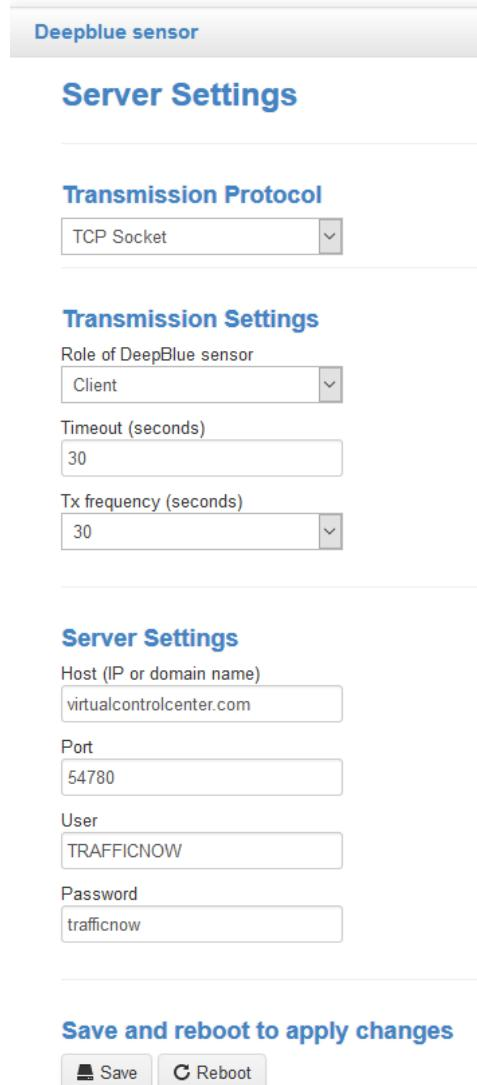
Slika 6: Konfiguracija senzora u modu rada kao klijent
