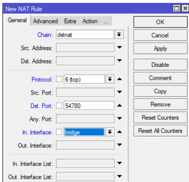
Slika 16: Konfiguracija otvaranja portova - ulazni port
