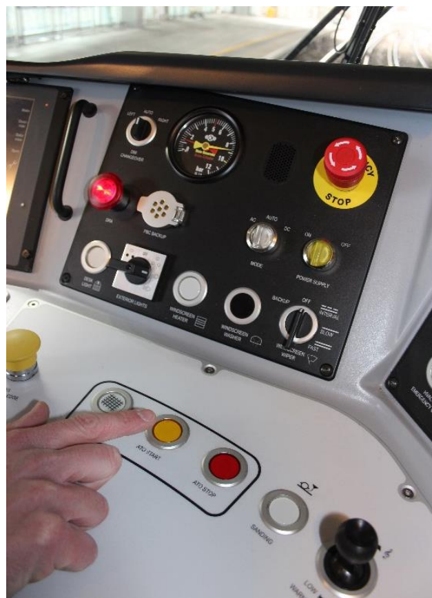
Slika 13. Prikaz kontrola u Siemens Class 700 vozilima opremljenim ATO sustavom
