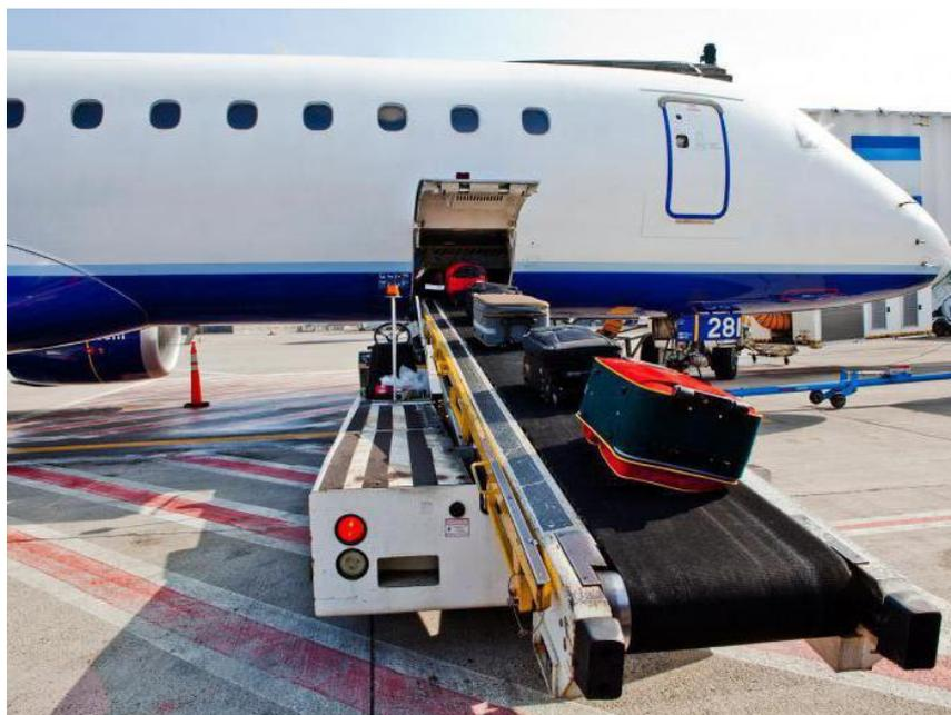
Slika 17. Mobilna traka za utovar i istovar prtljage, [12]
