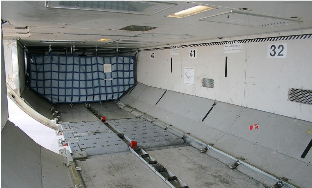
Slika 25. Označavanje granice visine utovara tereta
