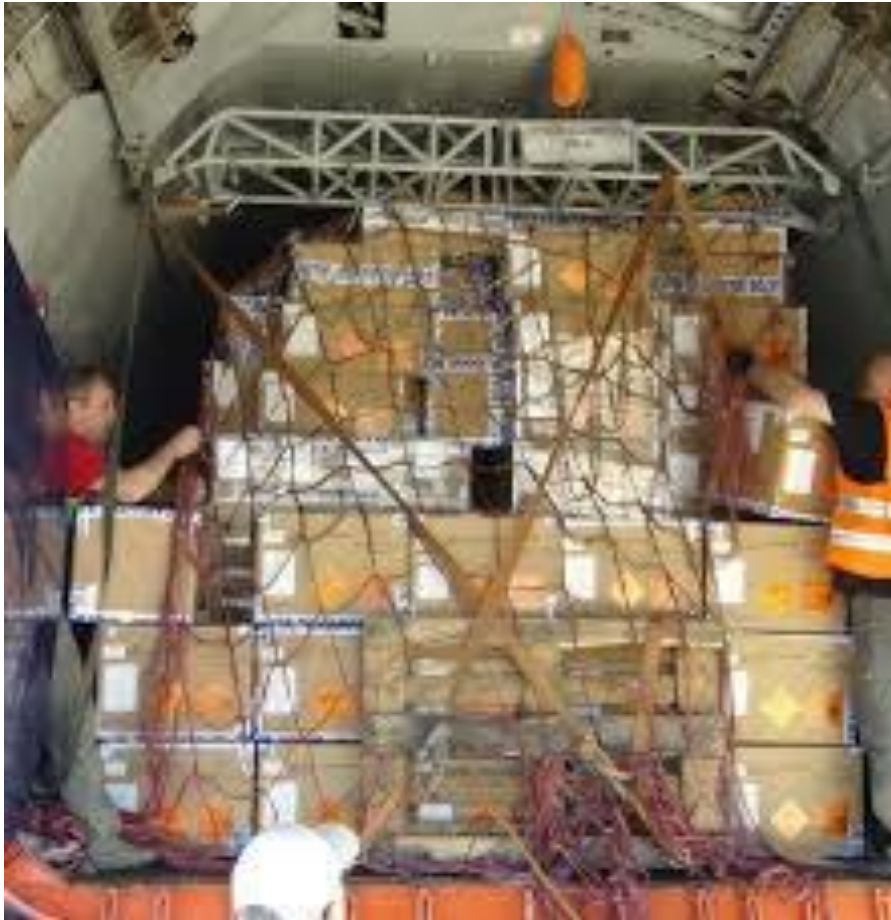
Slika 27. Primjer vezanja opasne robe u zrakoplovu
