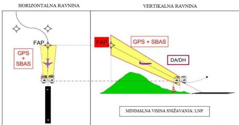
**Slika 4.8.** Prikaz generalnog APV - SBAS postupka prilaženja, [8]
