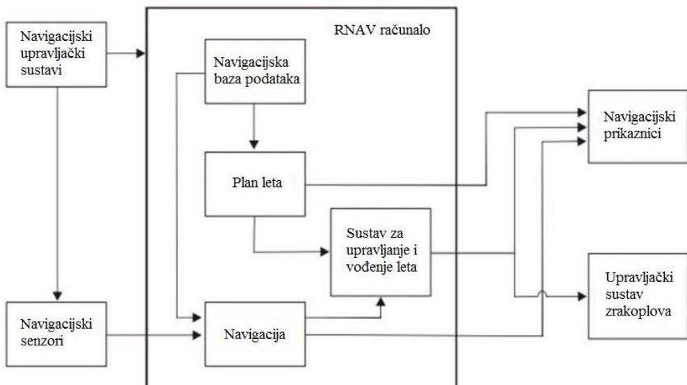
**Slika 2.4.** Prikaz komponenata RNAV sustava na zrakoplovu, [3]
