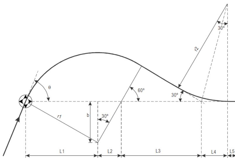
**Slika 5.6.** Prikaz komponenti zaokreta točke obveznog preleta, [9]
