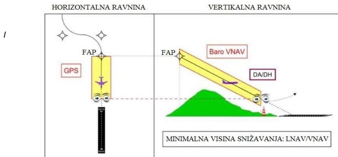
**Slika 4.6.** Prikaz generalnog APV Baro - VNAV postupka prilaženja, [8]
