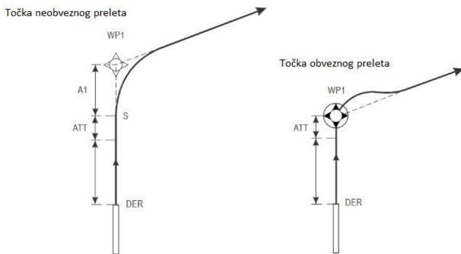
**Slika 5.12.** Prikaz konstrukcije postupka instrumentalnog odlaska s obzirom na smještaj prve točke, [9]
