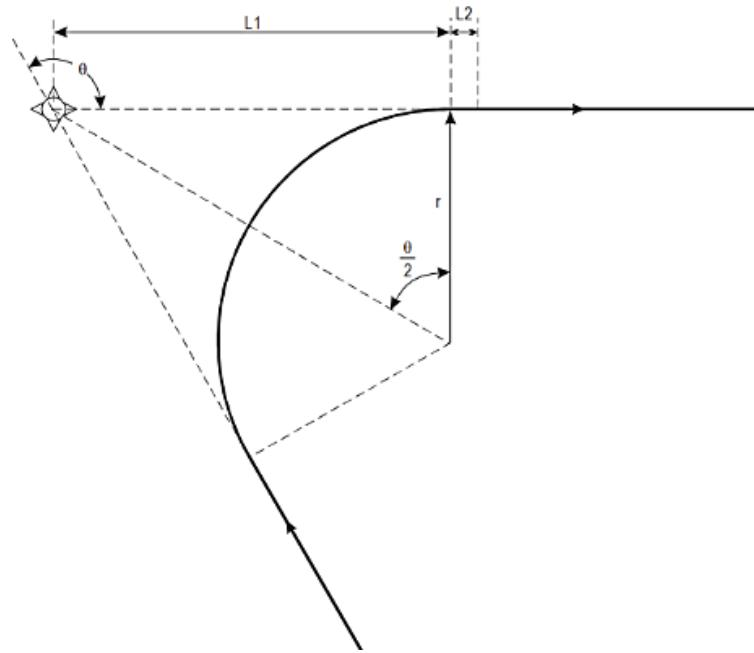
**Slika 5.7.** Prikaz komponenti zaokreta točke neobveznog preleta, [9]
