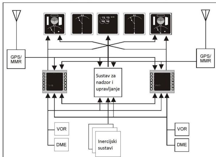
**Slika 2.3.** Prikaz različitih izvedbi RNAV sustava na zrakoplovu, [3]
