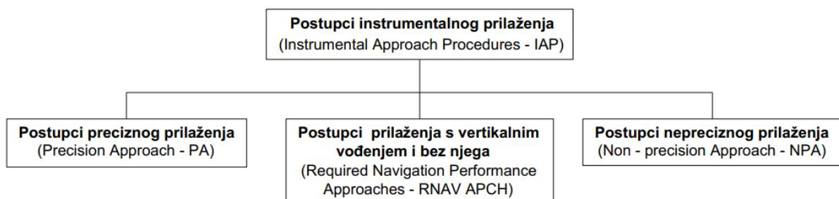
**Slika 4.1.** Klasifikacija postupaka instrumentalnog prilaženja, [1]
