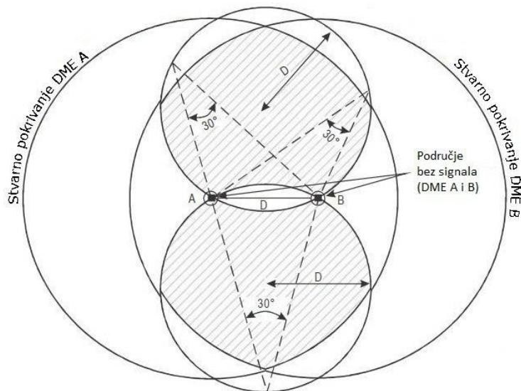
Slika 5.4. Pravilo DME/DME presjeka  $30^\circ/150^\circ$ , [9]
