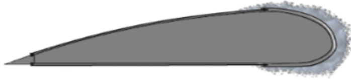
Slika 2.5. Neprozirni led na aeroprofilu [5]
