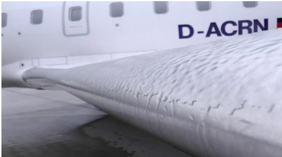
Slika 2.3. Prozirni led na krilu zrakoplova [6]
