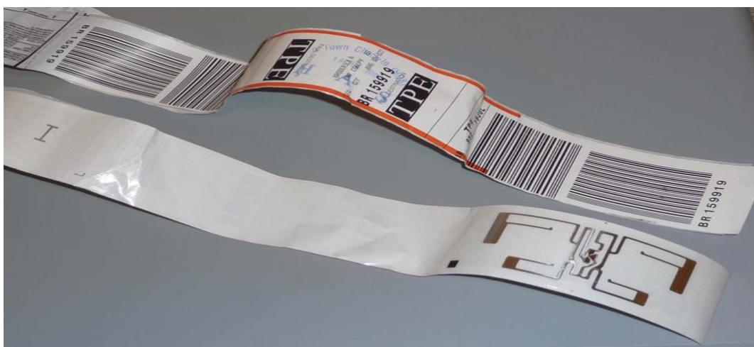
Slika 4. RFID prtljažni privjesak na prtljažnom privjesku
