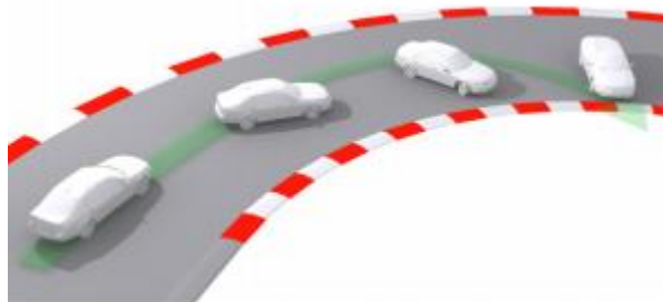
Slika 23. Preupravljivost vozila Izvor:[21]
