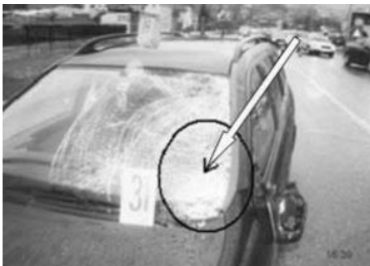
Slika 43. Fotografija oštećenja nastalih na vozilu Opel Izvor:[24]
