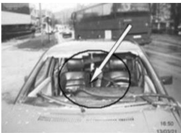
Slika 42. Fotografija oštećenja vjetrobranskog stakla vozila Golf Izvor: [24]
