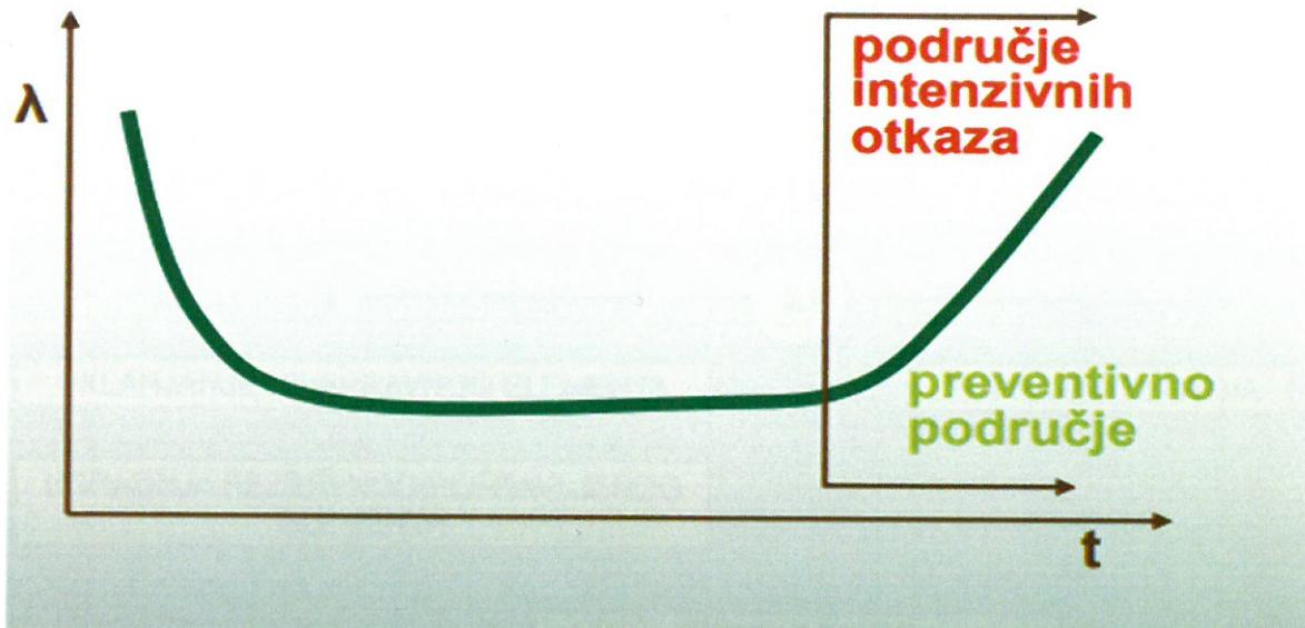
Slika 3. Graf ovisnosti intenziteta kvarova o vremenu [3]
