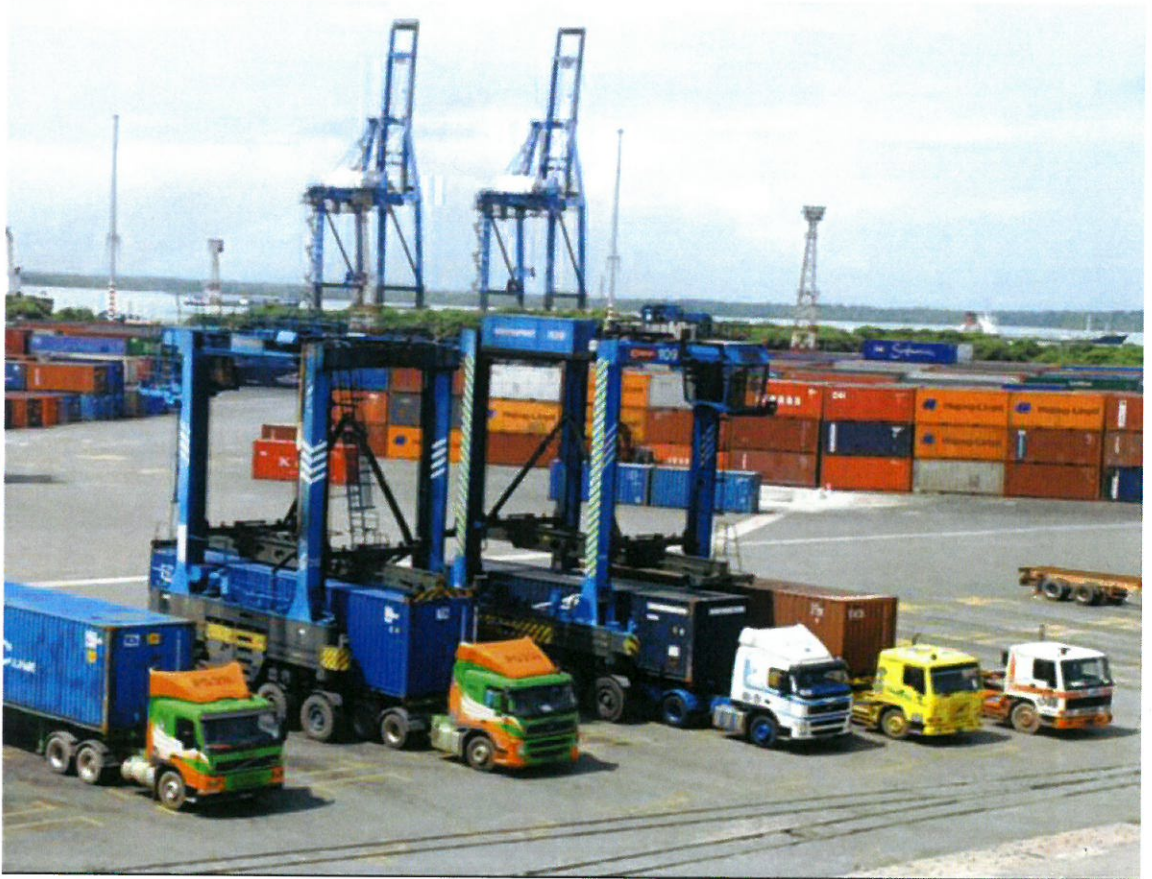
Slika 12. Portalni prijenosnik malog raspona
