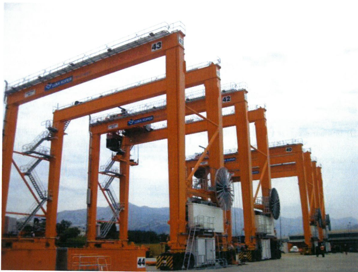
Slika 13. Prikaz RTG dizalice
