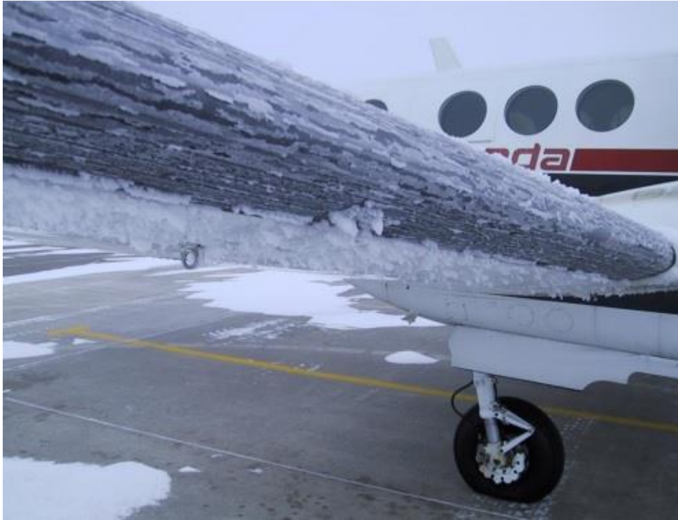
Slika 16. Prikaz leda na napadnim ivicama krila zrakoplova [22]
