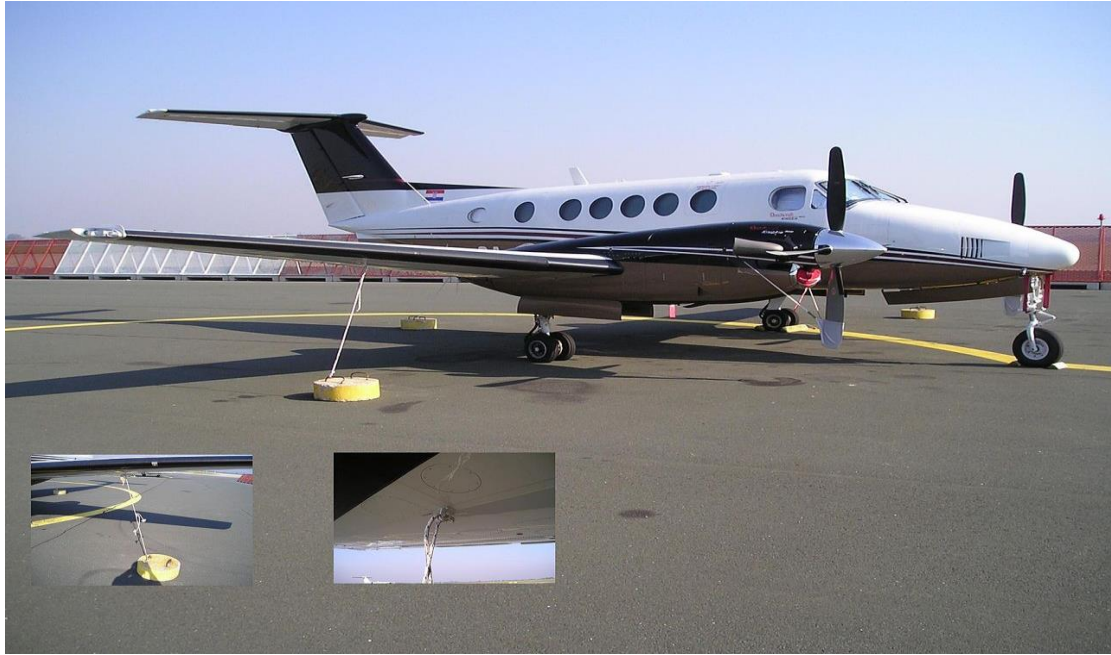
Slika 5. Sidrenje zrakoplova općeg zrakoplovstva [8]
