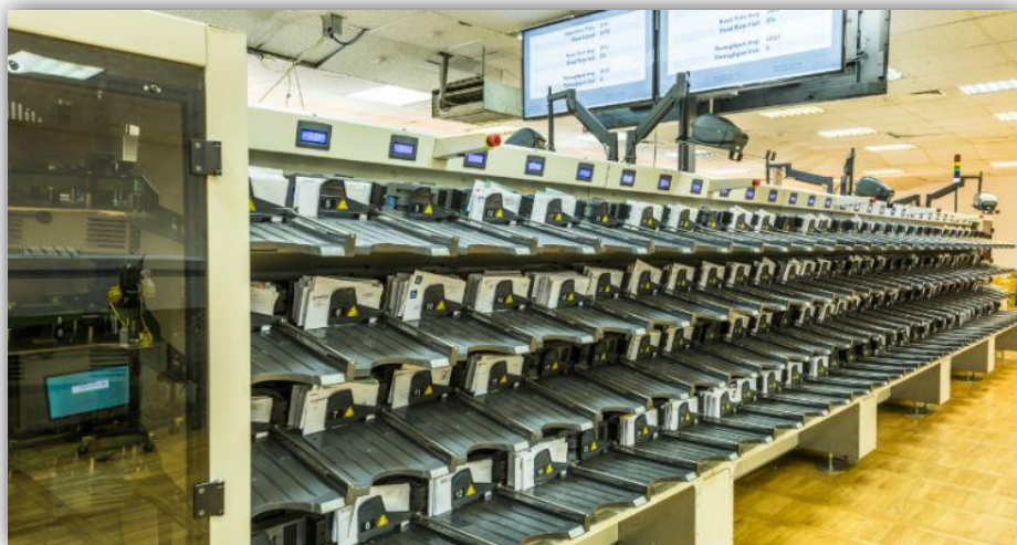
Slika 3. Prikaz stroja za automatsko sortiranje pismovnih pošiljaka Izvor: https://lider.media/wp-content/uploads/2017/10/SASP1.jpg (22.6.2019.)
