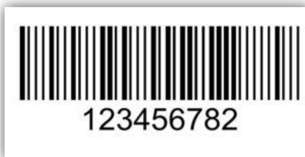
Slika 4. Prikaz jednodimenzionalnog barkoda
