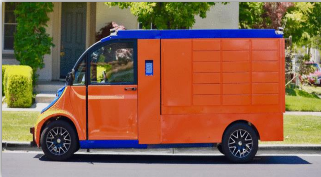
Slika 14. Prikaz autonomnog vozila s ormarićima
