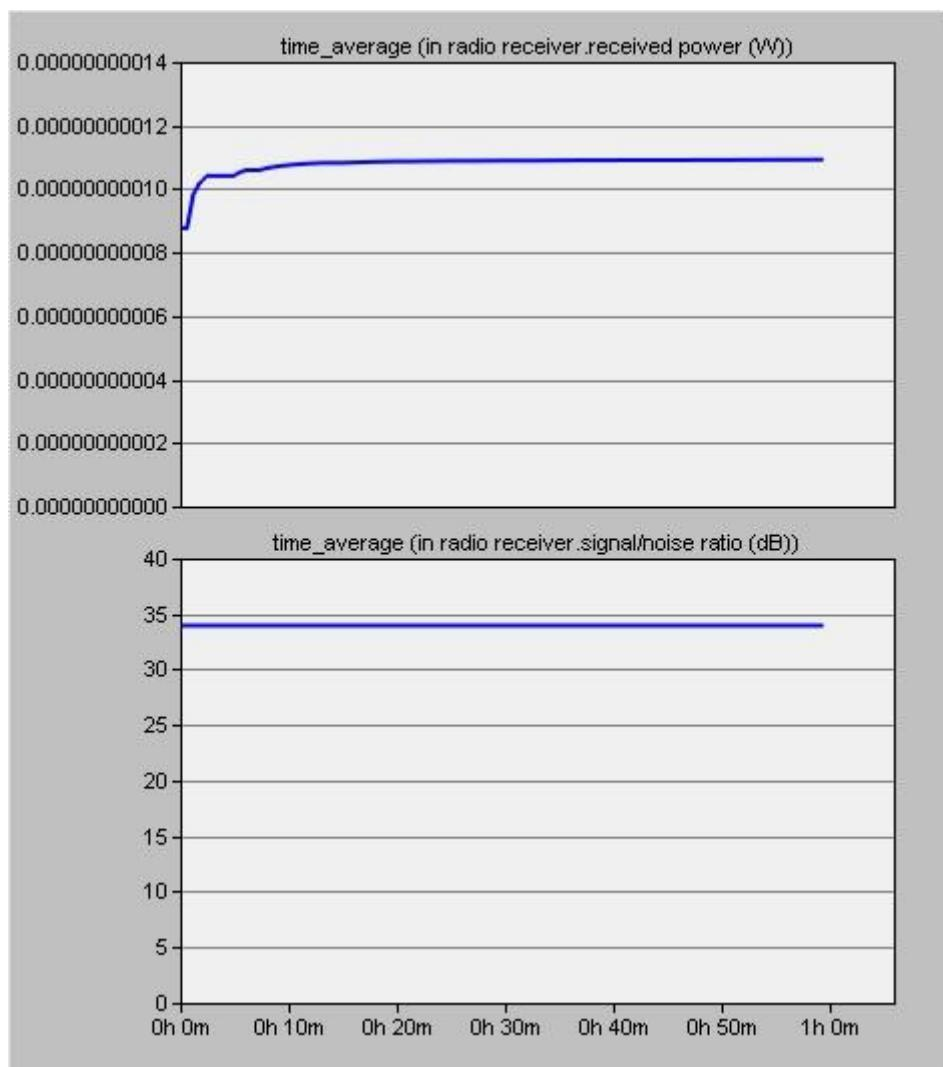
Slika 7.: Prosječna snaga prijemnog signala kao i omjera signal-šum
