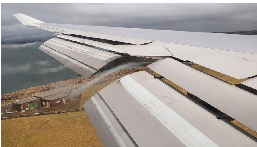
Slika 20.: Fowlerovo zakrilce s dva procjepa na krilu zrakoplova Boeing 747
