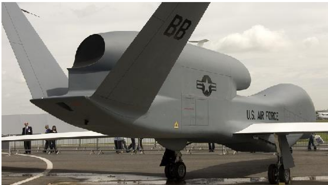
Slika 24.: Prikaz V-repa na zrakoplovu Northrop Grumman RQ-4 Global Hawk
