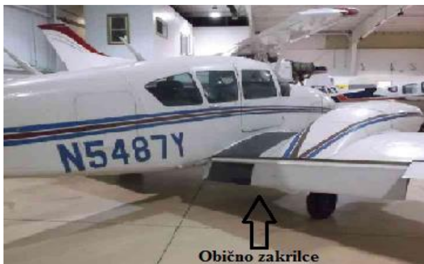
Slika 16.: Obično zakrilce na zrakoplovu Piper PA-23-250
