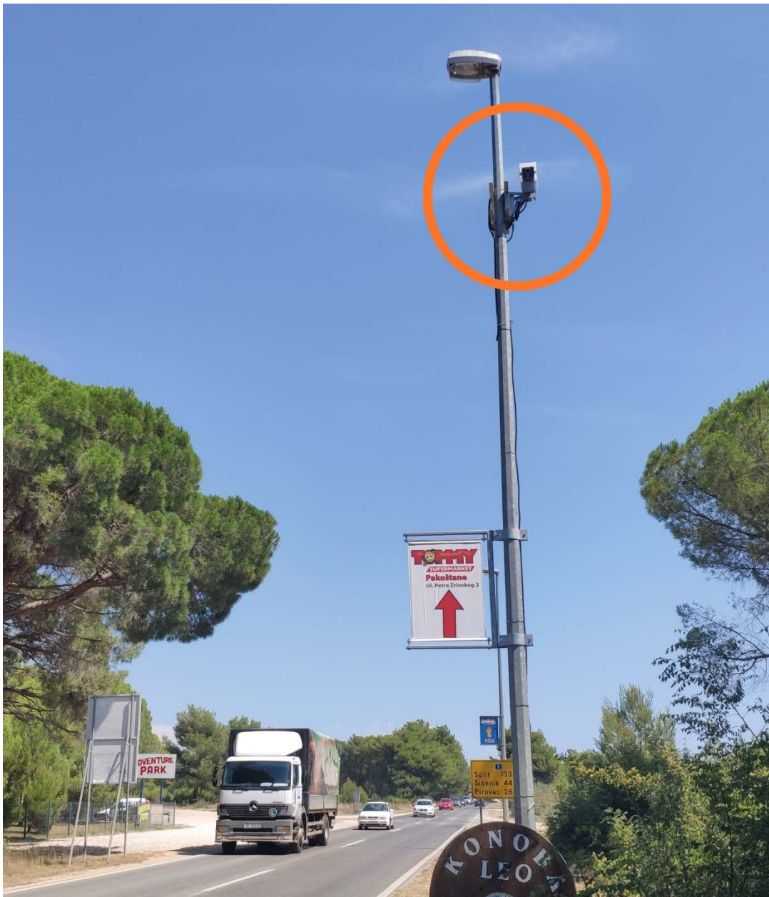
Slika 14. Kamera za praćenje brzine postavljena neposredno ispred predmetnog raskrižja
