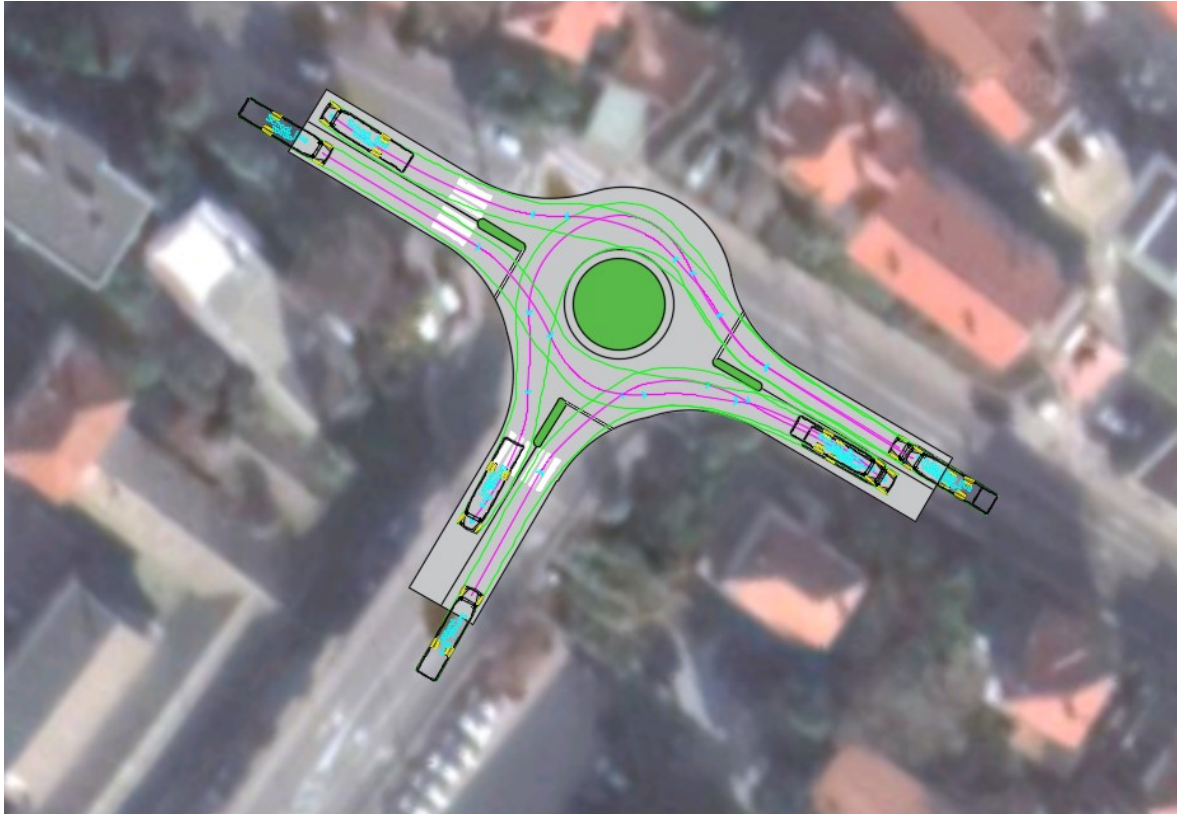
Slika 34: Provjera trajektorija za prijedlog rješenja raskrižja Splitski put- Ulica Vladimira Nazora
