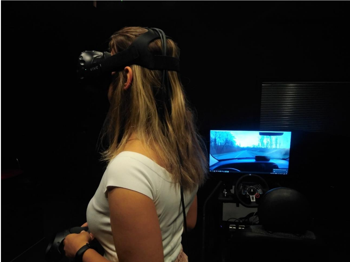
Slika 4. Prikaz ispitanika prilikom ispitivanja percepcije metodom korištenja VR naočala za reprodukciju videozapisa
