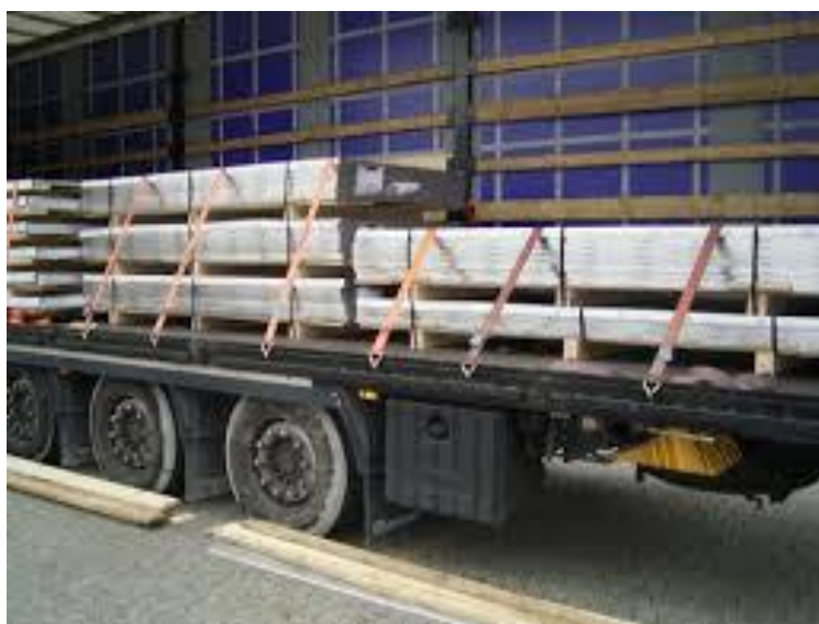
Slika 5.: Osigurane ploče na poluprikolici nakon utovara, [14]
