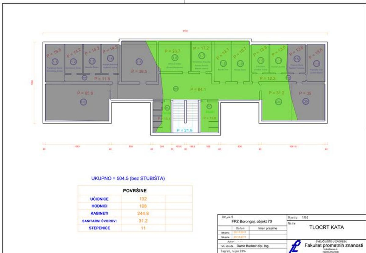
**Slika 23. Preklapanja signala na prvom katu objekta 70**
