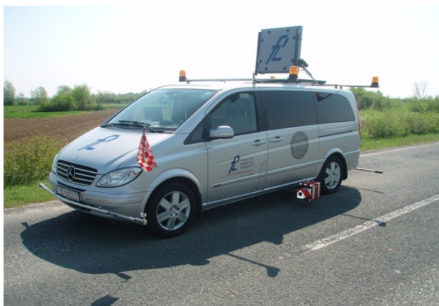
Slika 16. Mjerno vozilo s montiranim uređajem ZDR 6020
