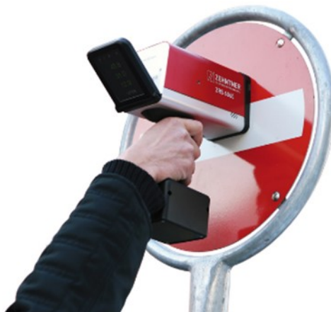
Slika 10. Izgled retroreflektometra za ispitivanje retroreflektivnosti prometnih znakova ZRS
