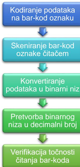
Slika 4. Osnovni princip rada bar-kodova
