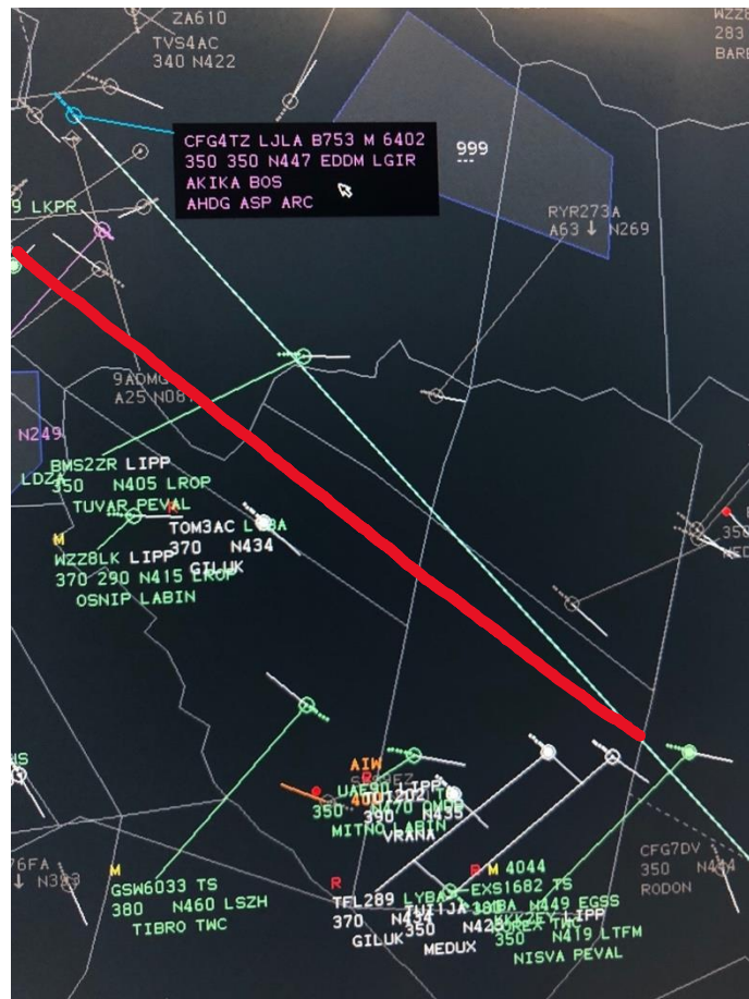
Slika 21 Prikaz ljubičasto obojenog labela zrakoplova u susjednom sektoru Centra oblasne kontrole zračnog prometa Zagreb
