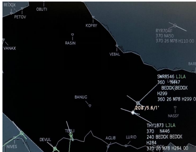
Slika 27 Uporaba QDM za očitavanje adekvatne horizontalne separacije
