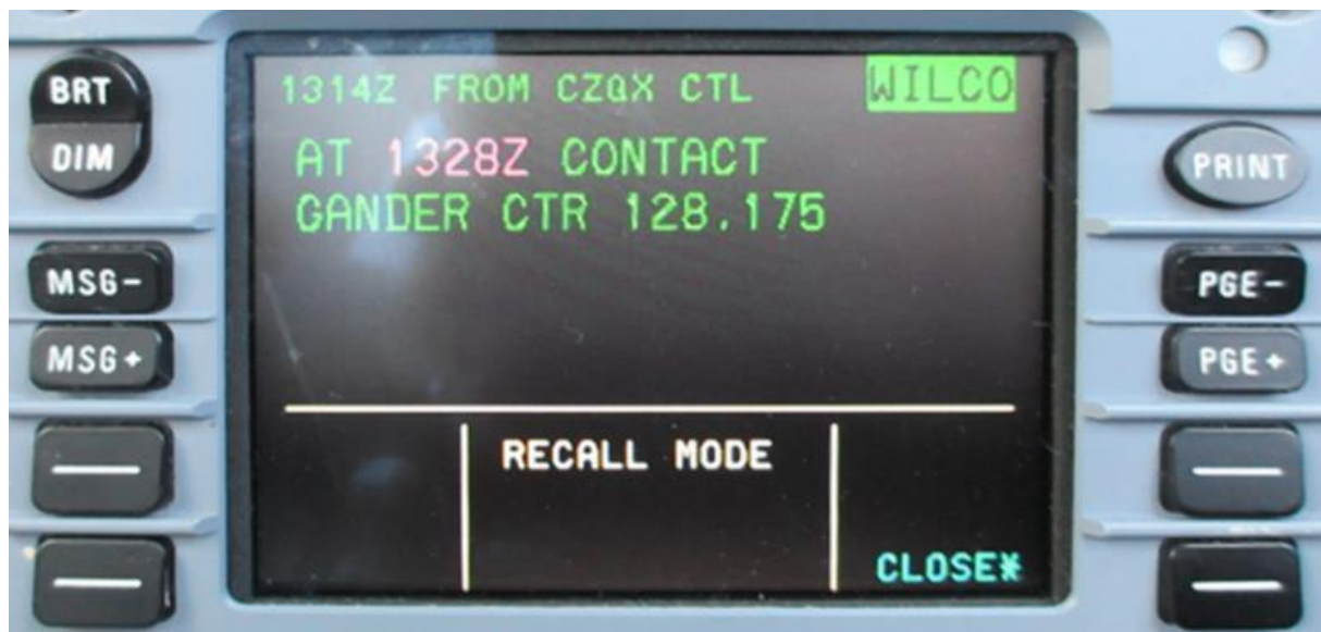
Slika 16 Prikaz pilotovog CPDLC ekrana
