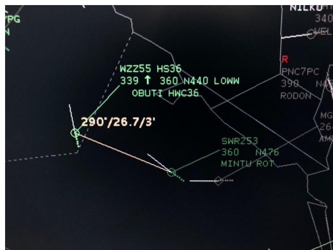
Slika 17 Alat QDM u sustavu Centra oblasne kontrole zračnog prometa Zagreb
