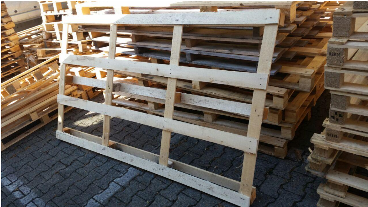
Slika 7. Paleta dimenzije 2130 x 1230 mm
