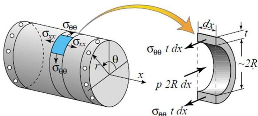
Slika 7. Dijelovanje sila na trup zrakoplova uslijed dijelovanja diferencijalnog tlaka [28]
