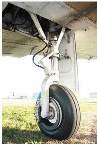
Slika 1. Čelik u konstrukciji stajnog trapa
