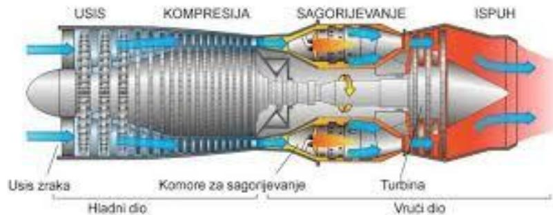
**Slika 13.** Dijelovi mlaznog motora [40]
