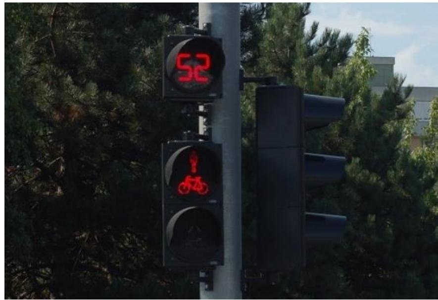
Slika 31. Brojač vremena na semaforskom uređaju, [9]
