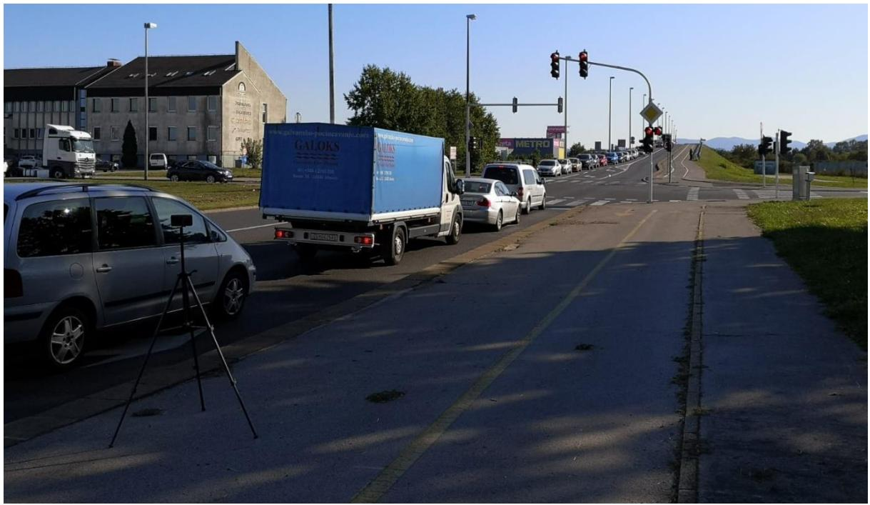
Slika 30. Mjerenje vremena napuštanja vozila iz raskrižja
