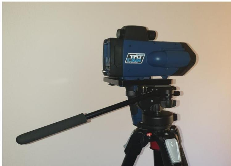
Slika 27. Uređaj za mjerjenje brzine TruCAM Laser Speed Gun
