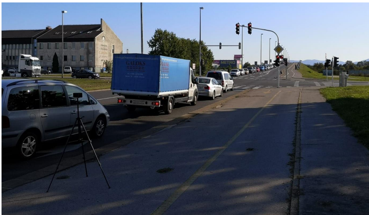
Slika 30. Mjerenje vremena napuštanja vozila iz raskrižja
