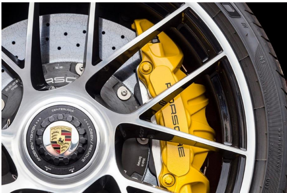
Slika 5: Keramički diskovi na automobilu Porsche Izvor: [8]
