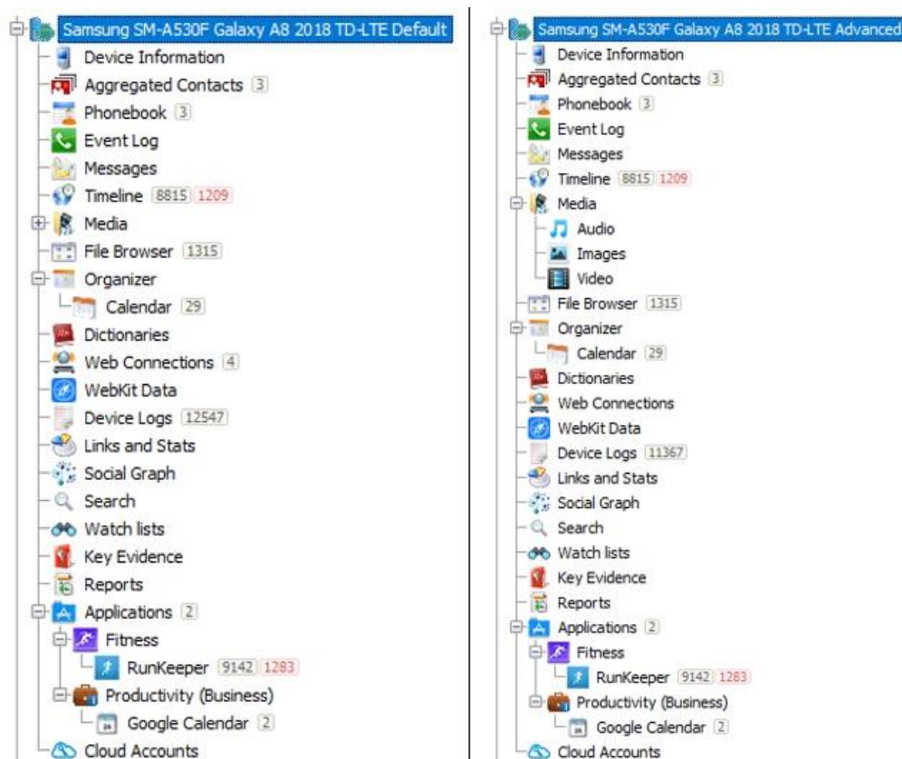
Slika 11. Usporedba metoda ekstrakcije podataka: zadani način rada (lijevo) i napredni način rada (desno)
