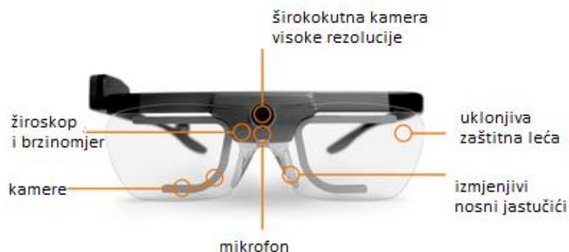
Slika 17. Naočale za praćenje pogleda Tobii Pro Glasses 2
