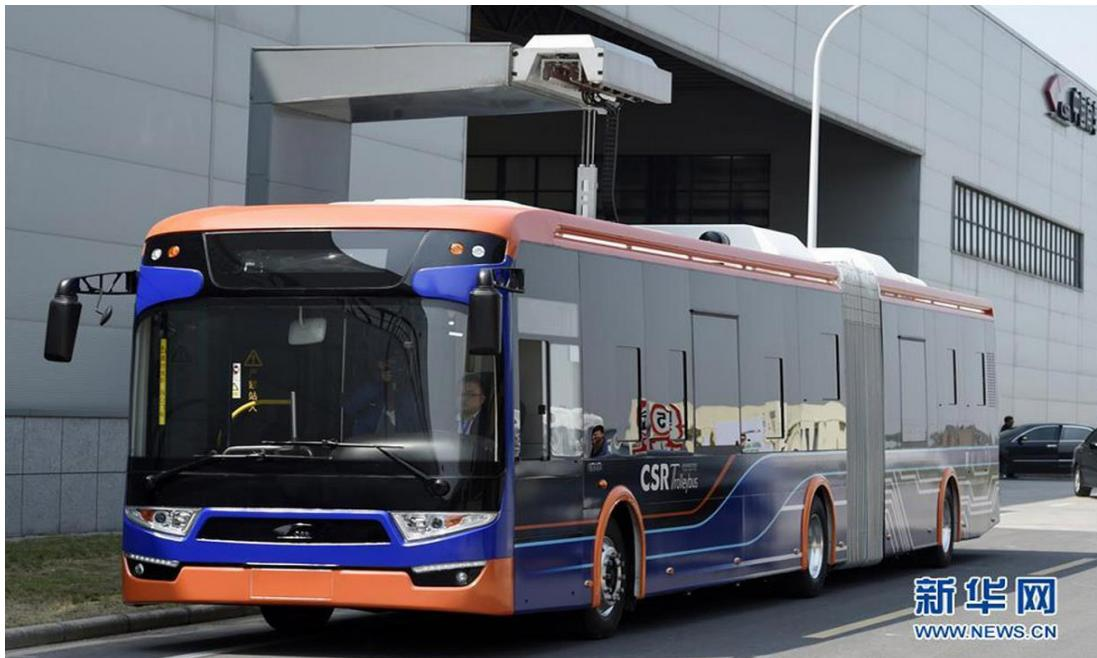
Slika 14. Punjenje superkondenzatora električnog autobusa
