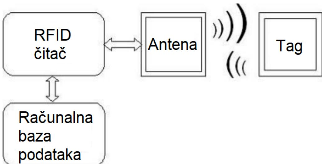
**Slika 5.** Blok dijagram RFID sustava
