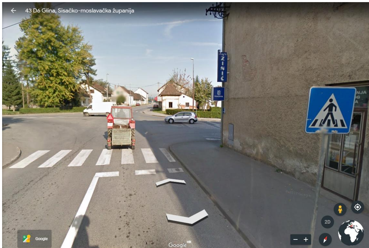
Slika 15. Prikaz infrastrukture koja smanjuje preglednost
