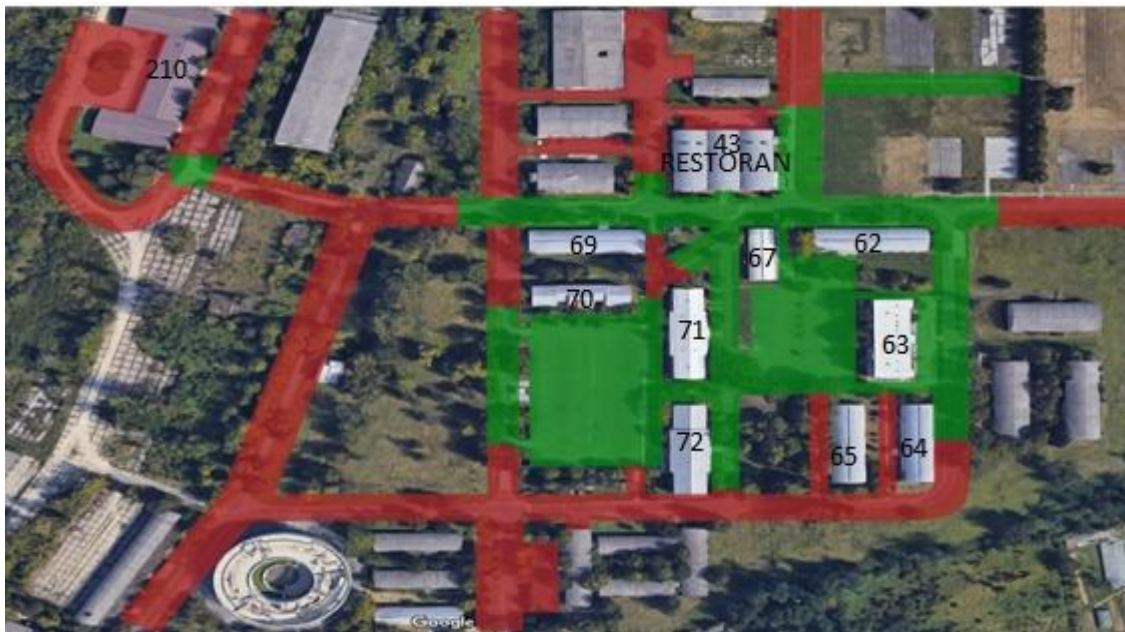
Slika 26. Prikaz područja prihvatljive i neprihvatljive snage primljenoga signala
