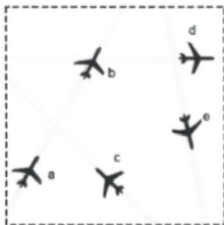
Slika 13. Horizontalne interakcije za izračun indikatora kompleksnosti [11]
