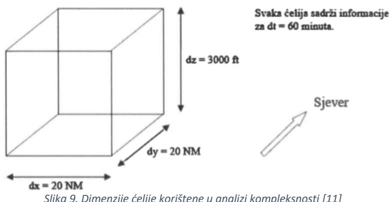
Slika 9. Dimenzije ćelije korištene u analizi kompleksnosti [11]
