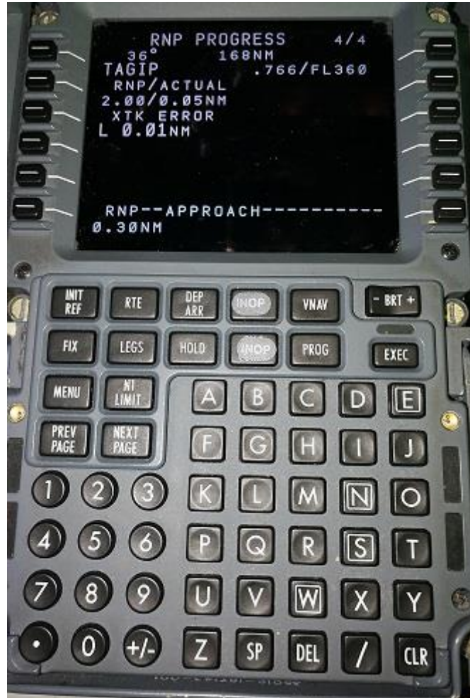
Slika 14. Prikaz RNP karakteristika unutar FMC-a
