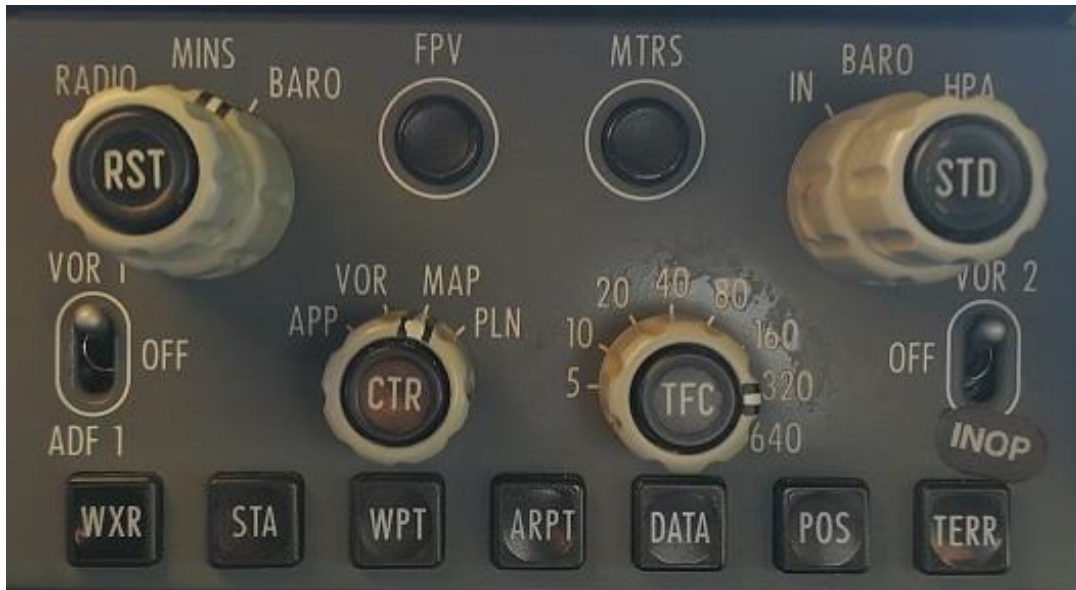
Slika 16. EFIS upravljačka ploča
