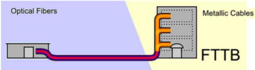
Slika 9. Prikaz optičkog vlakna do zgrade (FTTB) [3]
