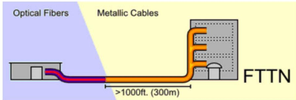
Slika 11. Optičko vlakno do ormarića/distribucijskog čvora Fiber to the Cabinet/Node[3]
