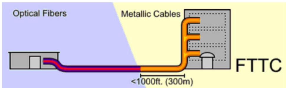
Slika 10. Prikaz optičkog vlakna do pločnika (FTTC) [3]
