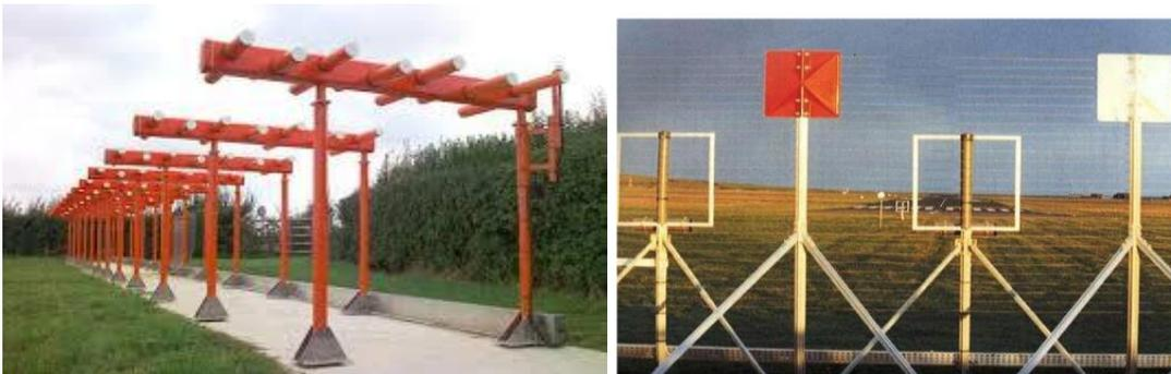
**Slika 5.** Primjer log-periodske antene i četvrtaste antene. [4]
