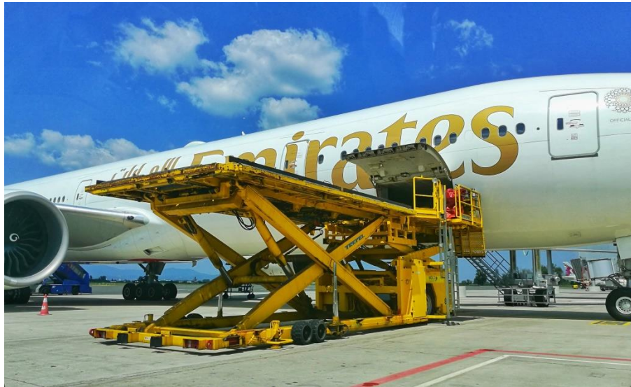
Slika 2 Cargo high loader - slozeno manipulativno sredstvo
