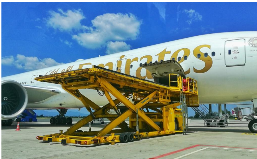
Slika 2 Cargo high loader - slozeno manipulativno sredstvo
