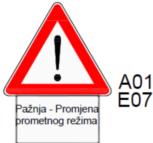
Slika 8. Obavezni prometni znak na montažnom raskrižju
