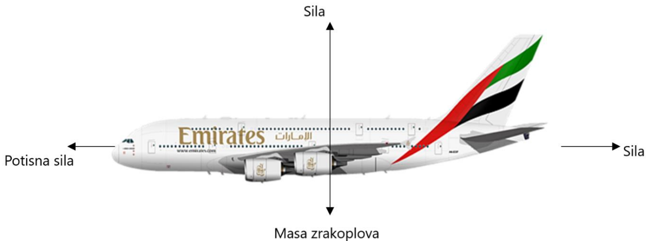
Slika 1. Djelovanje aerodinamičkih sila na zrakoplov
