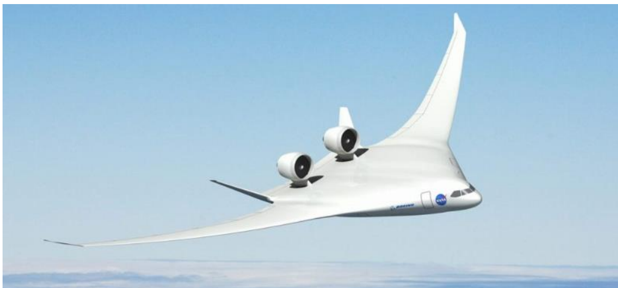
Slika 5. Prikaz BWB zrakoplova
