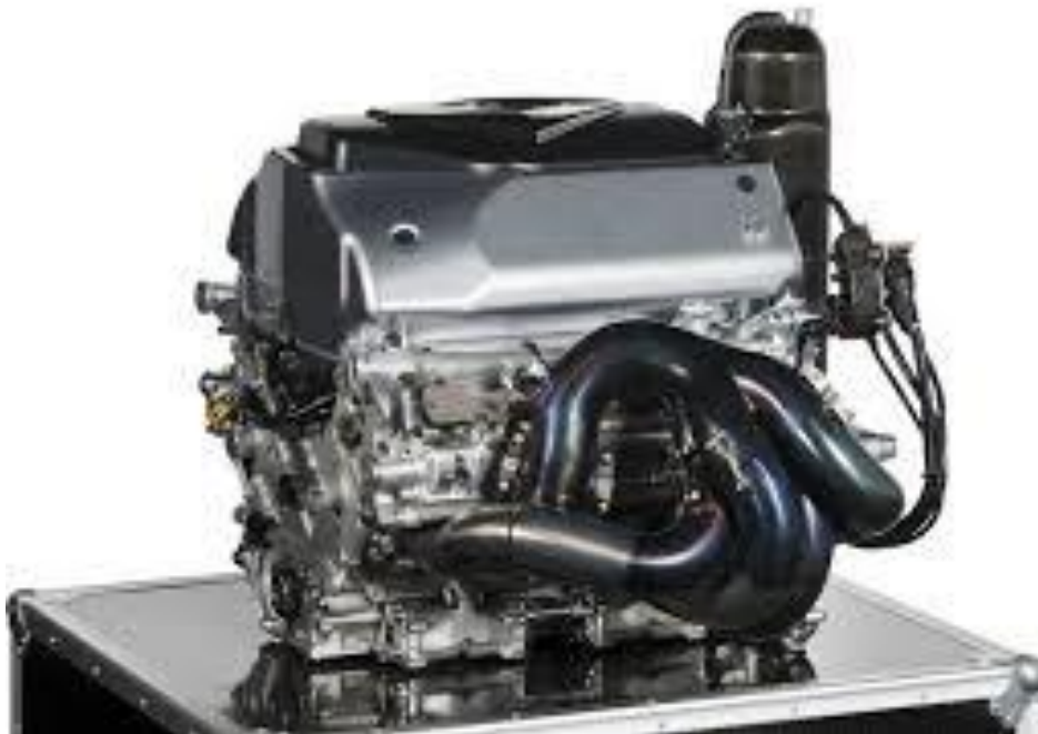
Slika 17. Renault RS27, V8 motor iz 2013. godine
