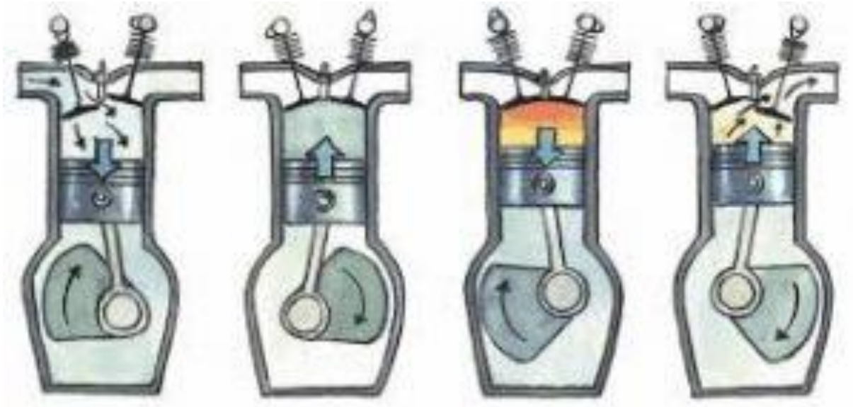
Slika 2. Princip rada četverotaktnog Diesel motora
